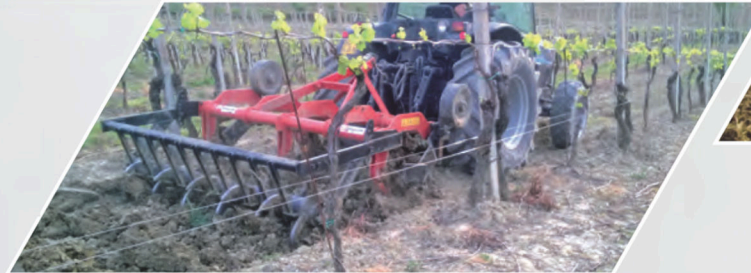
Scheibenegge mit gezackten Scheiben und hydraulischer Einstellung.
