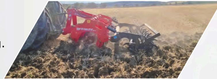
Doppel-Wellenscheibenegge mit hydraulischer Einstellung.
