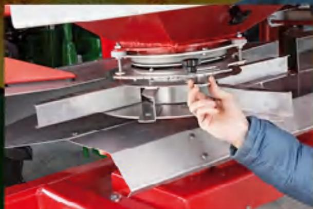
Das besondere Design erlaubt es, dass der Dünger seitlich auf die Streuscheiben auftrifft. Durch diese Arbeitsweise wird der Dünger sanft behandelt, Bruchkorn und Staubbildung werden vermieden.
