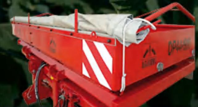
Behälterabdeckung mit Rollplane. Verhindert das Verschmutzen des Düngers, schützt vor Regen und Fremdkörpern.
