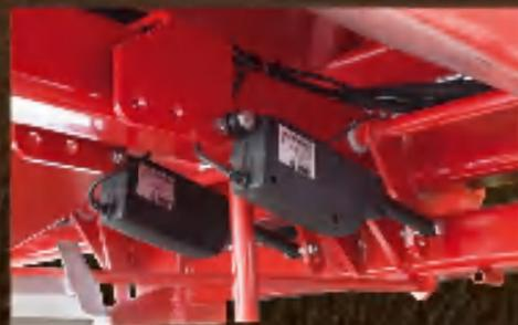
Vier Wiegezellen zwischen Trichter und Hauptrahmen des Düngerstreuer machen das System sehr zuverlässig, sie vermitteln dem Rechner immer das aktuelle Gewicht. Zusammen mit der GPS-Steuerung, erzielt es eine hohe Genauigkeit.
