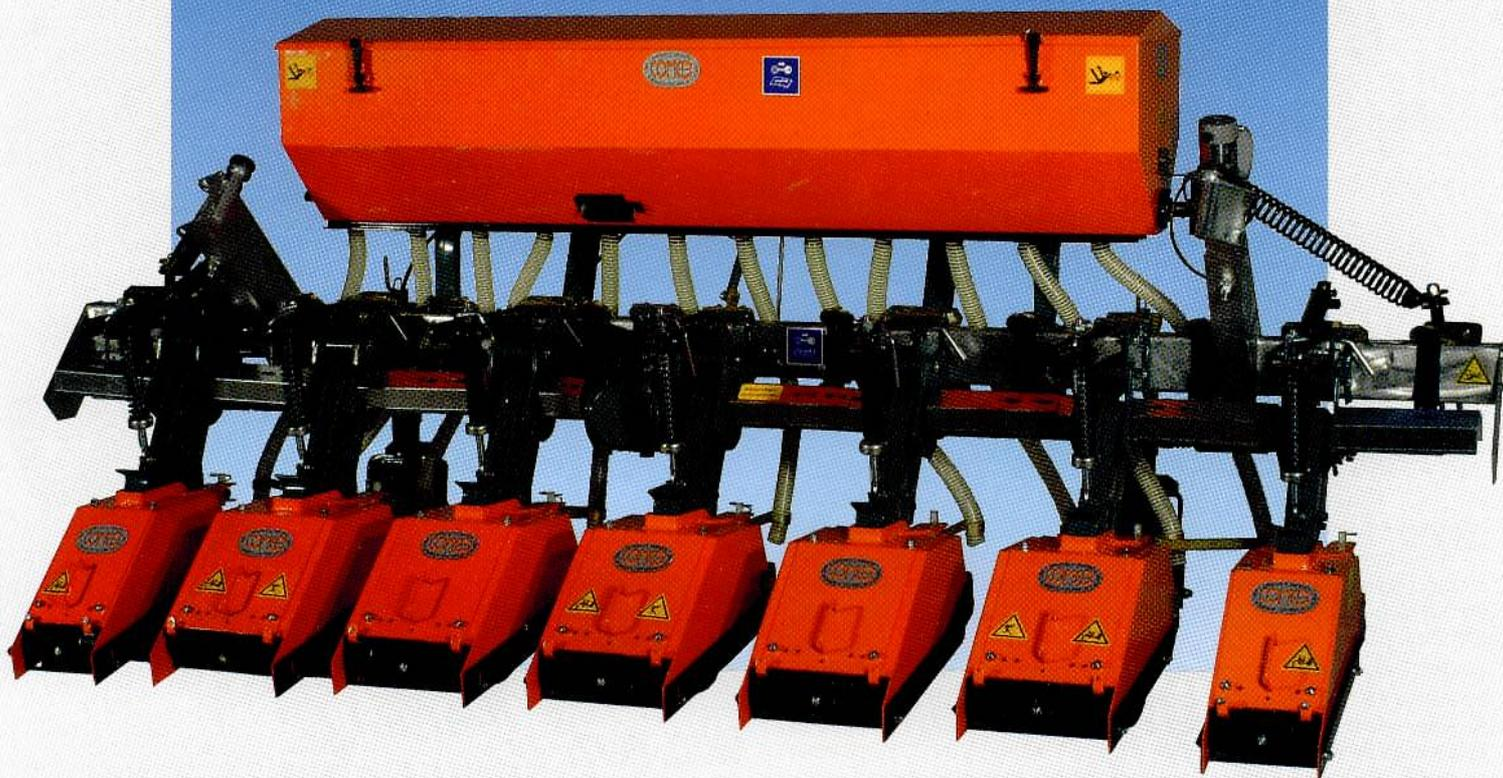
**I** Le fresatrici multiple COMEB sono il risultato di una ricerca moderna per la lavorazione di tutte le colture interfilari. Macchine altamente versatili composte da un telaio porta attrezzi, albero di trasmissione, attacco 3° punto, riduttore, ruote per la regolazione di profondità ed elementi fresanti indipendenti, trasformabili a seconda delle esigenze di lavorazione.
