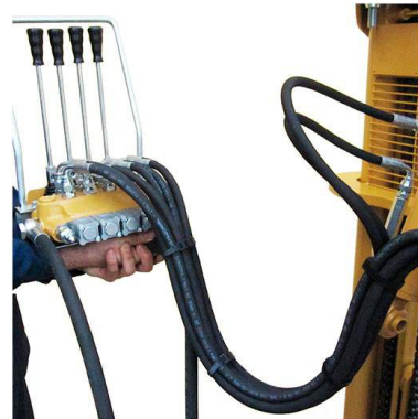
manuelle Fernbedienung mit 1,5m Schläuchen
