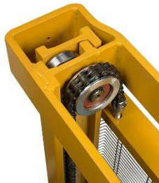
Warm gewalzte Laufschienen mit Zylinderrollenlagern
