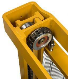
Warm gewalzte Laufschienen mit Zylinderrollenlagern
