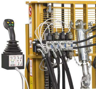
proportionale elektro-hydr. Steuerung
