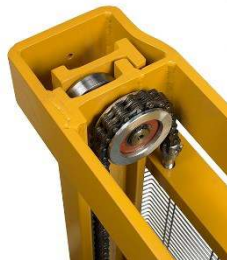
Warm gewalzte Laufschienen mit Zylinderrollenlagern
