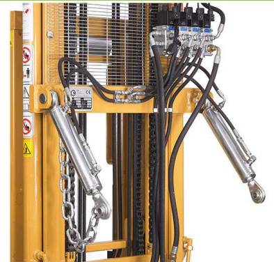
Spezialanbau mit 2 Neigungszyindern
